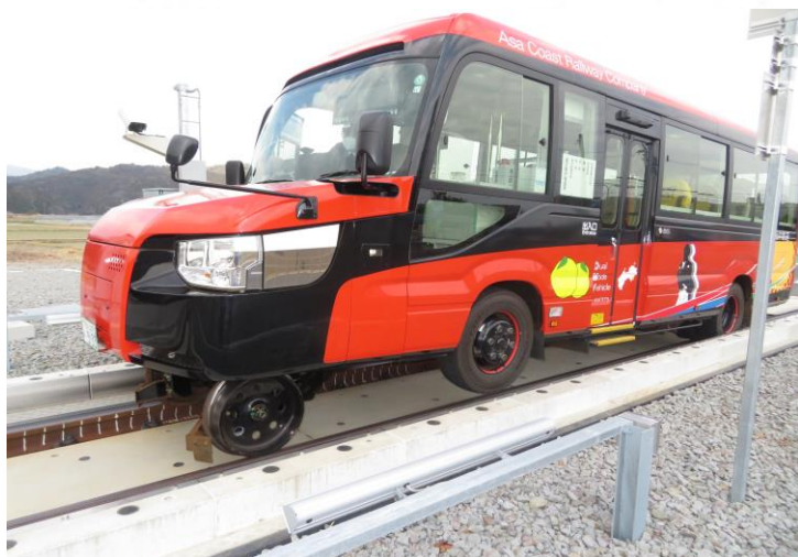
鉄輪をレールに乗せ前輪ゴムタイヤを浮かすDMV=阿波海南駅で
